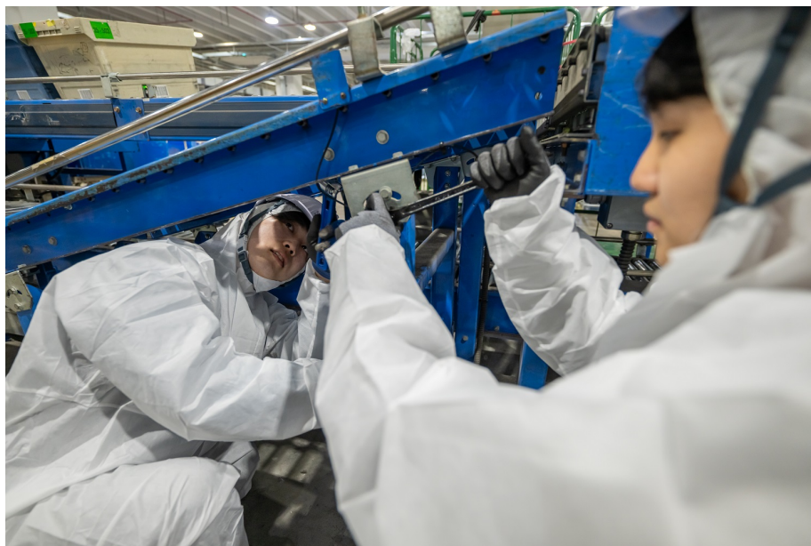
Coupang酷澎物流服務自動化團隊Han-Kyungjoo（左）正調整FC內排出滑槽導軌支架的角度。
